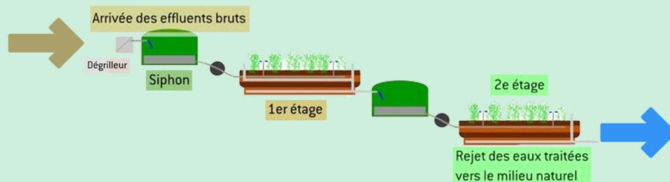
**Schéma de principe station d'épuration**
